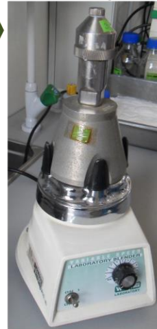
Mechaniczne uwolnienie mikrospor
